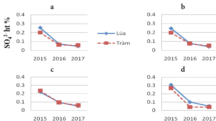
Hình 5. Diễn biến hàm lượng Sunfat hòa tan ( SO_4^{2-} ht) tại các điểm đất phèn giai đoạn 2015 - 2017 (a: tầng 1, b: tầng 2, c: tầng 3, d: tầng 4)
