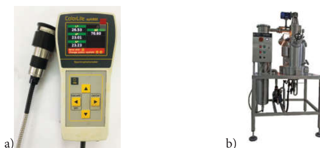
Hình 2. a) Máy đo màu ColorLite sph860 (Đức) và b) Hệ thống thiết bị cô đặc chân không
